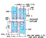
NOTES: 1. TRACE WIDTH IS SHOWN FOR ROGERS RO4350B WITH DIELECTRIC THICKNESS. 0.30" ± .00.2"; COPPER: 1/2 0.7. EACH SIDE. FOR OTHER MATERIALS TRACE WIDTH MAY MEED TO BE MODIFIED. 2. BOTTOM SIDE OF THE POB IS CONTINUOUS GROUND PLANE.
